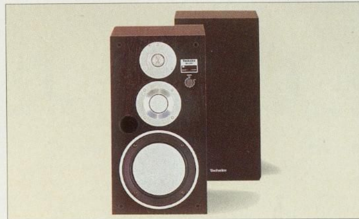
SB-X 300 3-Weg-Lautsprecherbox mit Wabenscheiben-Flachmembran. Baßreflex-System. Pegelregler für Hochtöner. Überlastungsanzeige mit Schutzrelais. Belastbarkeit: 55 W Sinus/110 W Musik. Impedanz 8 Ohm. Gehäusefarbe: rosenholz.
