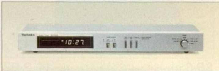
SH-4020 Zeitschaltuhr mit digitaler FL-Anzeige. Schaltmöglichkeit: 1 Programm in 24 Std. Max. Anschlusslast 1.200 W. Breite: 43 cm. Gehäusefarben: schwarz und silber.
