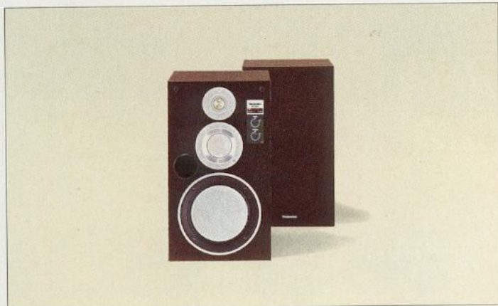
SB-X 500 3-Weg-Lautsprecherbox mit Wabenscheiben-Flachmembran. Baßreflex-System. Pegelregler für Hochtöner und Mitteltöner. Überlastungsanzeige mit Schutzrelais. Belastbarkeit: 65 W Sinus/130 W Musik. Gehäusefarbe: rosenholz.
