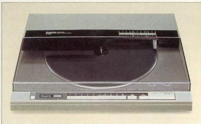
SL-QL 15 Vollautomatischer Plattenspieler mit quargeregelterm Direktantrieb und Tangentialtonarm. Musik-Selektor für bis zu 10 Musikstücke. Wiederholautomatik. TNRC-Zarge. Gleichlaufschwankungen: \pm 0,035\% . Magnettonabnehmer EPC-P 33. Gehäusefarben: schwarz und silber.
